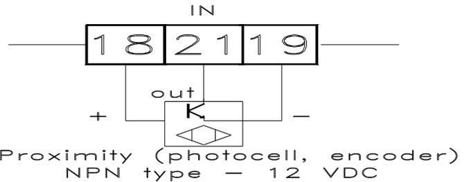
In funzione della frequenza del segnale fornito all'ingresso CNT è consigliabile impostare il filtro software del par. "H" che permette di selezionare la massima frequenza di ingresso accettabile per il conteggio ed evitare così conteggi indesiderati (causati ad esempio dai rimbalzi dei contatti).
