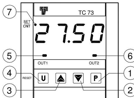
**1 - Tasto P** : Utilizzato per l'impostazione dei set point e per la programmazione dei parametri di funzionamento
